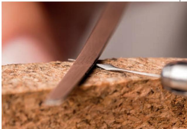
最初に金属板から針の輪郭を切り取り、ダイヤモンドやすりで形を一本ずつ整えます。手作業で時間をかけて仕上げられた針は立体的なフォルムが印象的です。その後、木製回転盤を使ったフリーハンドでのポリッシュ仕上げを施すことでさらに艶やかな光沢が生まれます。細長く繊細な針の先端部分はかすかに弧を描きながら研ぎ澄まされており格別な視認性を誇ります。
