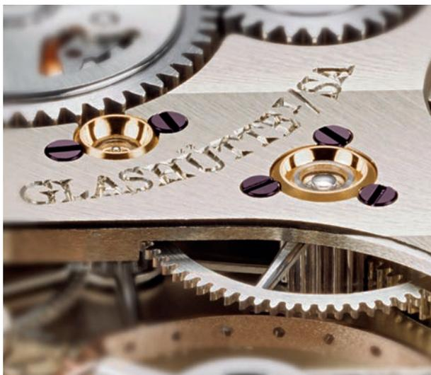
盛り上がったゴールドシャトンにはホワイトサファイアの受け石と、針と同じように焼き戻してブラウンバイオレットに発色させたスチール製の平型ネジを用いており、ムーブメントに独特の深みを与えます。
