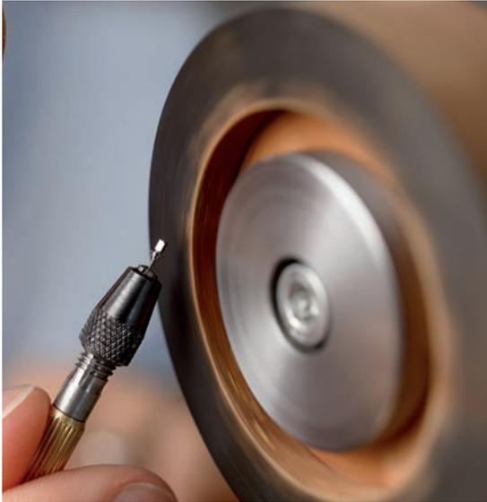
ムーブメントを組み立てた際には隠れてしまう内部のパーツであっても、すべての部品のエッジ部分は木製の回転盤、もしくは手作業で正確に面取りされ、数度にわたるポリッシング加工を経て銀色に輝く特徴的な仕上がりとなります。面取り部の角度と幅を一定に揃えるには熟練した技巧と高度な目測が必要です。
