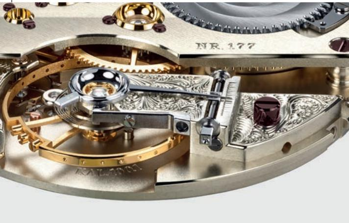
モリッツ・グロスマンの懐中時計に倣ってデザインされた片持ち式の段差式テンプ受けには、独自のマイクロメータースクリューが採用されています。ヒゲゼンマイの長さを調整し時計の精度を向上させるために、この精密調整ネジによる緩急針が用いられています。
