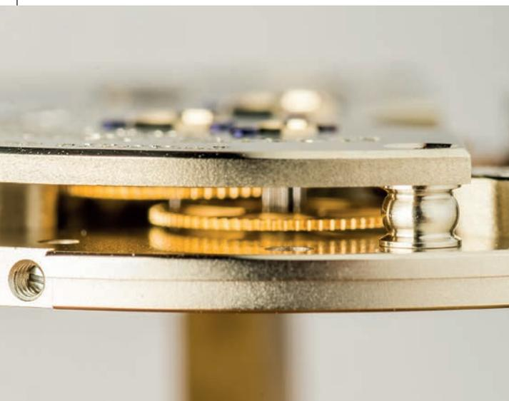
一般的なブリッジ方式の代わりに地板と3分の2プレートからなる古典的な支柱構造を採用しました。ムーブメントを側面から確認し、必要に応じて即座に輪列のあがきを調整できます。丸みを帯びたフォルムが美しい支柱はグラスヒütteの歴史的な懐中時計へのオマージュです。
